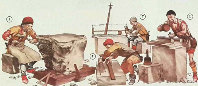
١ نقش على الحجر بالمطرقة والسنبك ٢ قياس رسم على الحجر بالبيكار والمسطرة ٣ قطع حجر بمنشار إطاري ٤ صنع حلية معمارية بأداة قاطعة
